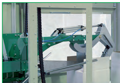
NCF-470 mit vollautomatischer Deckelzufaltvorrichtung
