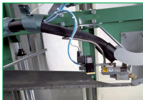
NCF-520-HMT mit Hot-Melt-Düsen
